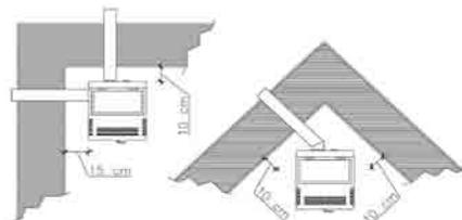
Falls der Ofen in der Nähe einer holzverkleideten Wand aufgestellt wird, oder das Rauchabzugsrohr mit ähnlichen Materialien in Berührung kommt, muss eine entsprechende Isolierung mit feuerfesten und feuerbeständigen Material erfolgen.
