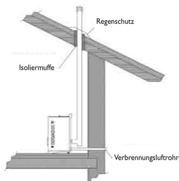
Nachdem der Ofen bei einem bereits bestehenden gemauerten Schornstein installiert werden muss, muss das Rohr über die gesamte Länge des Schornsteins verlegt werden, um die Bildung von Kondensat zu vermeiden, das Flecken auf der Mauer verursachen könnte.
